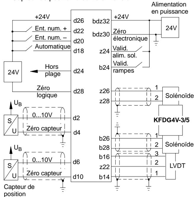
▲ Les montages comprenant un autre modèle d'amplificateur ou d'appareil hydraulique présenteront des différences au niveau des connexions de solénoïde et de LVDT: voir le catalogue 2464 pour l'amplificateur de base EEA-PAM-5\*\*-A-32 correspondant.
