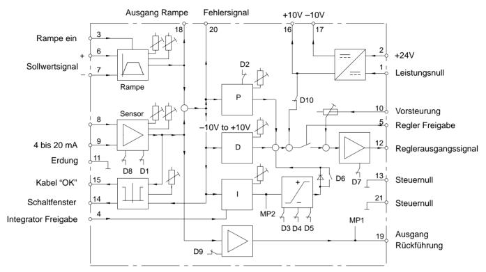
Hinweis: Das unbenutzte Eingangssignal Kontakt 6 oder 7 muß mit dem 0V-Anschluß (Kontakt 11, 13 oder 21) verbunden werden.
